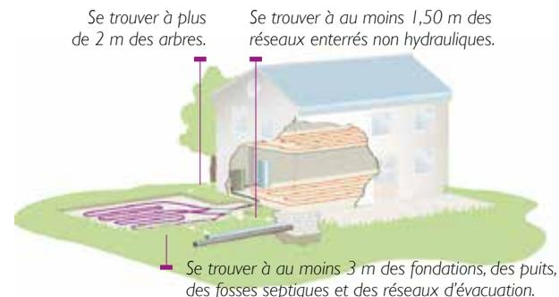
La surface au-dessus du capteur doit être perméable (pas de terrasse ou de construction) et ne pas être traversée par des réseaux d'eau (risque de gel). Le terrain ne doit pas être trop pentu, pour ne pas avoir à faire de remblai. Dans un sol rocheux ou argileux, il est préférable d'installer les capteurs sur un lit de sable.
