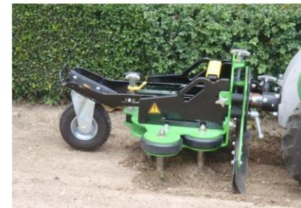
Désherbage mécanique à disques horizontaux sur motoculteur
